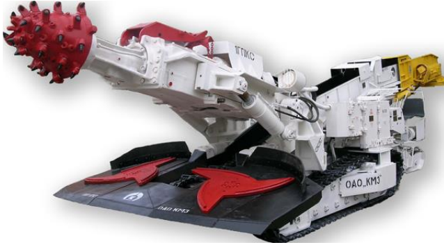
Figur 12. Automatisk maskin för urborrning av malm i valbara riktningar.
