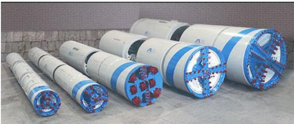
Figur 10. Fullortsborrar i olika dimensioner och utföranden (källa: [7]).
