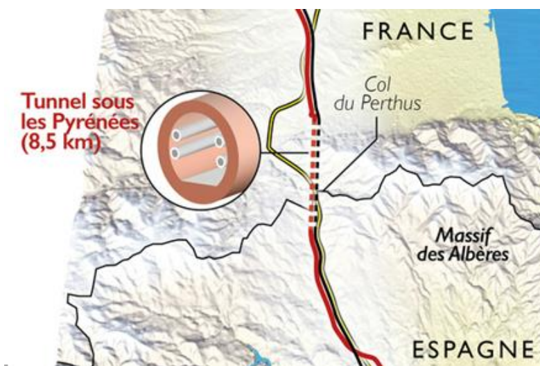
Figur 8 Bergtunneln genom för högspänd ström mellan Frankrike och Spanien (källa: [6]).
